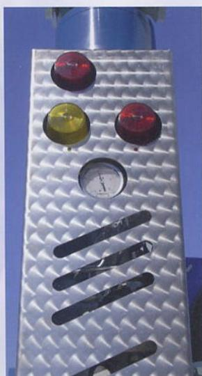
Manometro e flash indicatori dello stato di carico della gru
