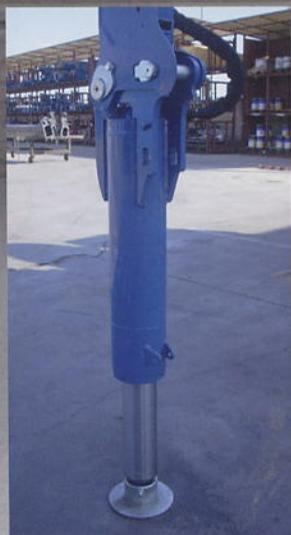
Cilindro stabilizzatore ribaltabile 180° (OPZIONE)
