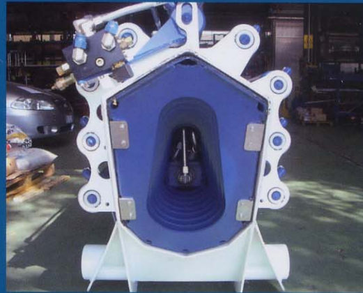
Sezione poligonale delle prolunghe, sistema CORMACH The boom extension with polygonal structure, CORMACH design Polygonal Ausschube, CORMACH System Bras a structure polygonale, Système CORMACH
