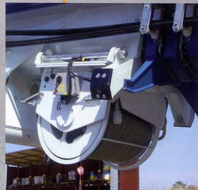
Verricello tiro diretto 4000 daN - (OPZIONE) (2500 daN con JIB) 4000 daN (2500 daN with JIB) winch on first line - (OPTIONAL) Treuil de tir direct 4000 daN (2500 daN avec JIB) - (OPTIONAL) 4000 daN (2500 daN JIB) Winde am ersten Seil - (AUF FRAGE) Cabrestante tiro directo 4000 daN (2500 daN JIB) - (BAJO PEDIDO)
