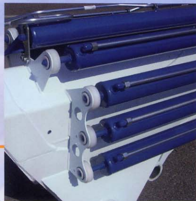
Attacchi cilindri snodati Moving cylinders connections Bewegliche Zylinder Halterungen Fixage de vérin basculant
