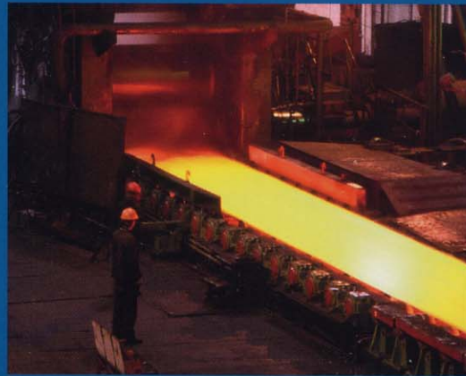
LAMIERE Le gru CORMACH sono realizzate utilizzando lamiere ad altissima resistenza con tensione minima di snervamento, in funzione del modello, che può raggiungere i 1300 N*mm 2 .
