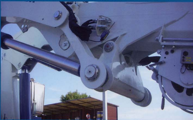
Articolazione con Biella e Puntone Articulation with link Articulation de bras Kniehebel am Knickarm Articulación con biela y puntal
