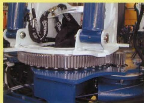
Rotazione tramite motore idraulico, riduttore e freno ad intervento negativo, possibilità' di avere la rotazione continua (in opzione). Kit rotazione 420° in opzione.
