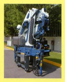
Compattezza: 21,77 m (71' 5") (versione E4F64) di braccio idraulico - 22000 daN\*m (159160 lb\*ft) (versione 22500 E4-E5-E6), 23000 daN\*m (166391 lb\*ft) (versione 225000 E1-E2-E3) di capacità in uno spazio di 0.91x2.500x2.287 m (2'12"x8' 2"x7' 6") (0.94x2.500x2.287 m (3' 1"x8' 2"x7' 6") con serbatoio).
