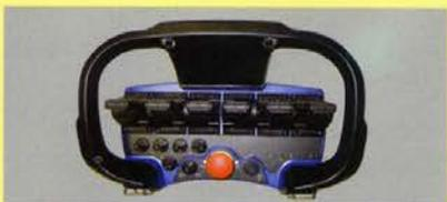
**Radiocomando con raggio d'azione di 100 m di serie; completo di carica-batterie e di collegamento a cavo (senza emissione di onde radio) per uso in emergenza nel caso di mal funzionamento del radio o delle batterie.**
