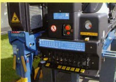
**Pannello di controllo con spia luminosa di intasamento filtro e conta-ore fondamentale per la programmazione della manutenzione.**
