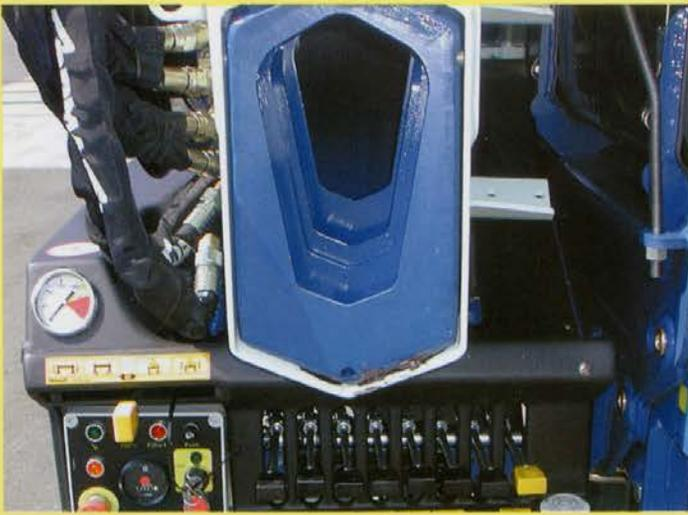
Braccio esagonale in materiale ultra resistente; rottura garantita minima pari a  $980 \text{ N/mm}^2$  (140.000 psi) con una unica saldatura nella parte compressa.
