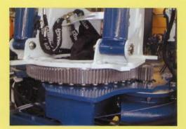
Rotazione tramite motore idraulico, riduttore e freno ad intervento negativo, possibilita' di avere la rotazione continua (in opzione). Kit rotazione 420° in opzione.
