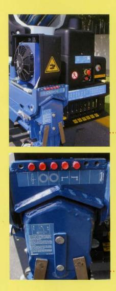
Posto di manovra in armonia con tutte le normative riguardanti l'ergonomia e la sicurezza e completo di bolla per il posizionamento in piano della gru.
