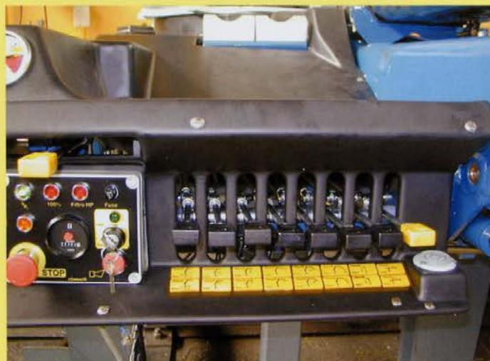
Posto di manovra in armonia con tutte le normative riguardanti l'ergonomia e la sicurezza e completo di bolla per il posizionamento in piano della gru.
