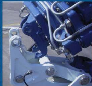
Aggancio/Sgancio rapido JIB Quick connection and disconnection of the JIB Connexion rapide de Jib Schnellkupplung des Jib (für die Hydraulik: hydraulische Schnellkupplung) Enganche/desenganche rápido del JIB
