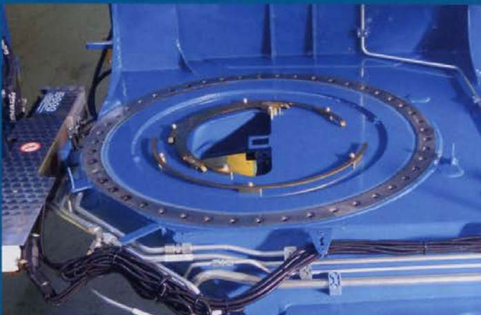
Rolla di Ø Maggiore rispetto alla concorrenza = Migliore distribuzione dei carichi Slew bearing with bigger Ø than the competition = Better distribution of the stresses Drehkranz mit einem größeren Ø als Wettbewerb = Bessere Verteilung der Belastung Couronne avec Ø plus important de la concurrence = plus correcte distribution de stress
